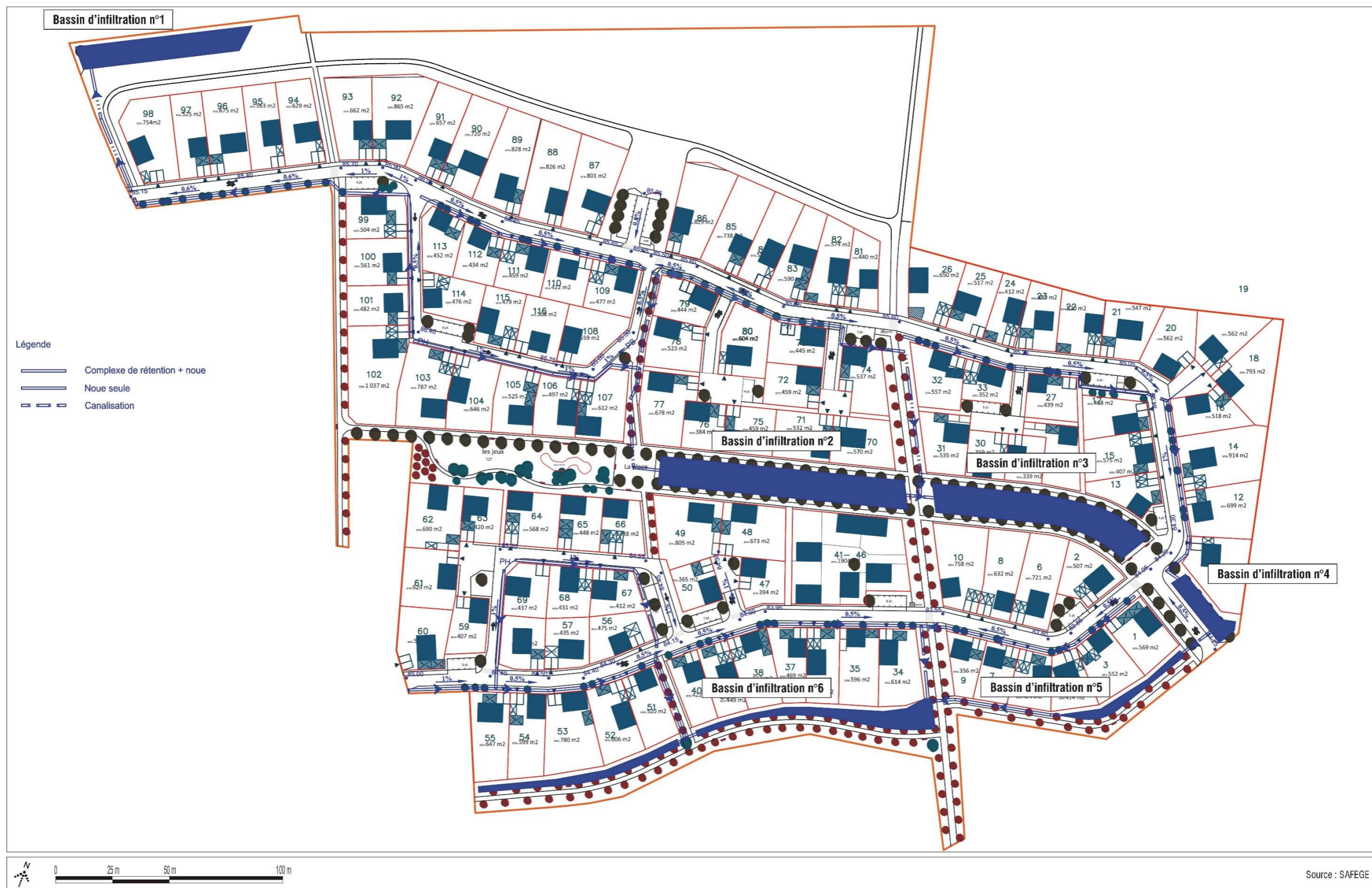
Figure 60 : Esquisse gestion des eaux pluviales
