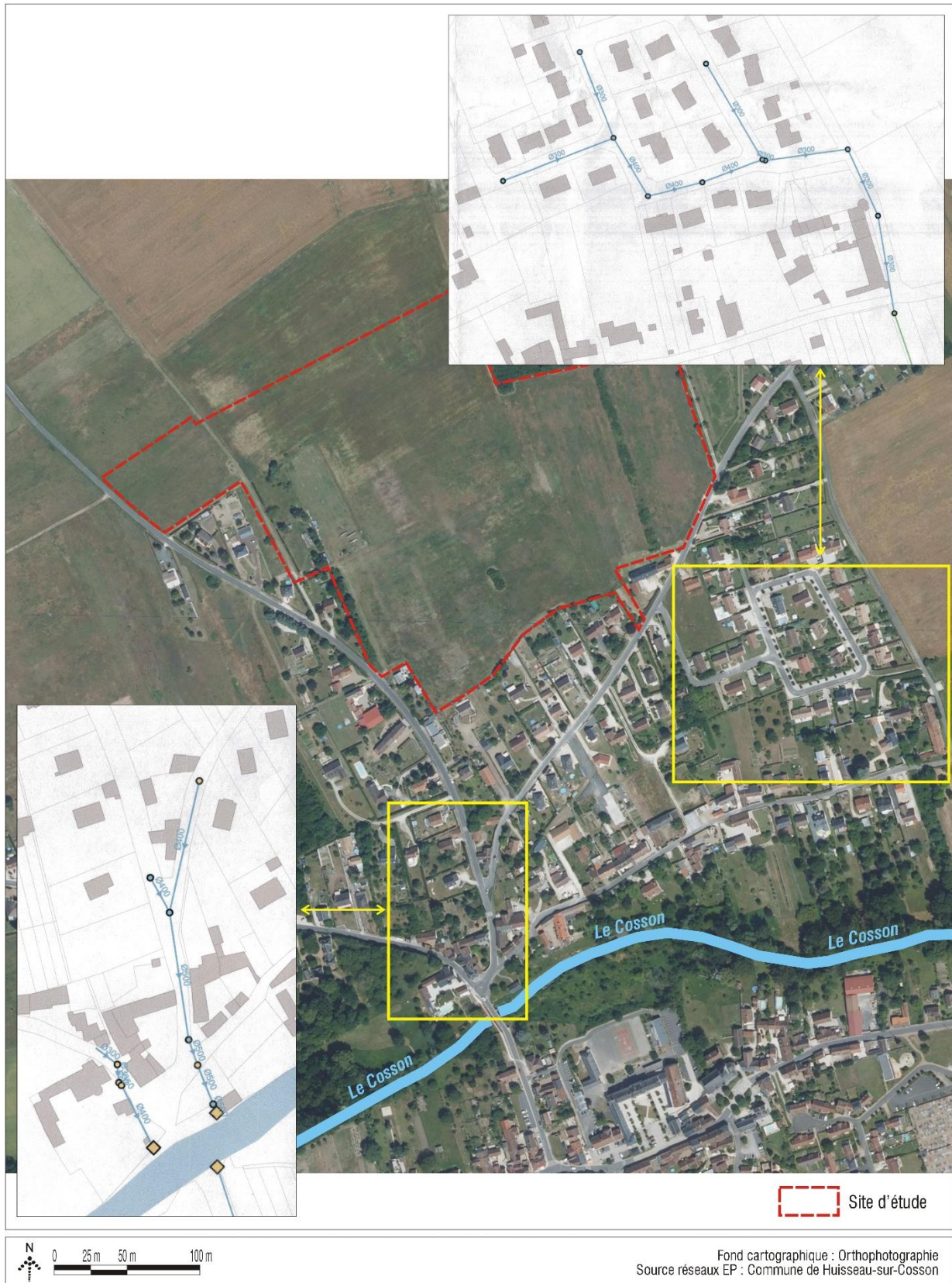
Figure 55 : Réseau d'eaux pluviales communal à proximité
